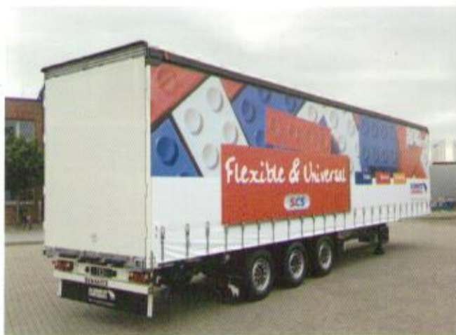
Uniwersalna naczepa z układem Varios Top Technology umożliwiającym regulowanie wysokości dachu i zawieszania
